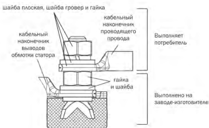
Рисунок 5. Схема контактного соединения.
